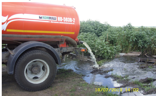
Сброс на почву сточных вод без очистки из ассенизаторской машины
